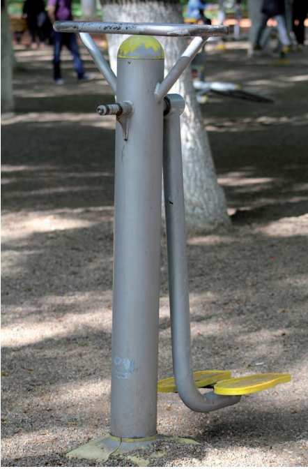
Resim 6. Hareketli aksamı kopmuş bir bel esnetme aleti
